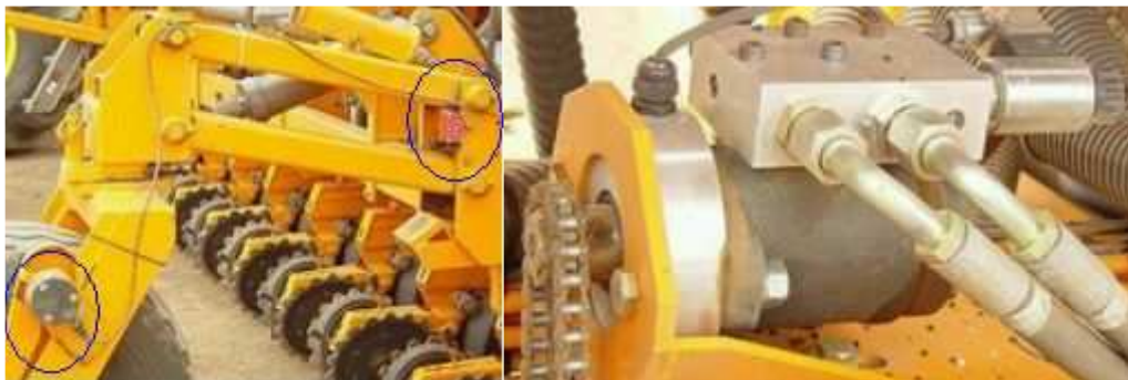
Fig. 5: sensor en la rueda y activador de siembra cuando la máquina está clavada.
