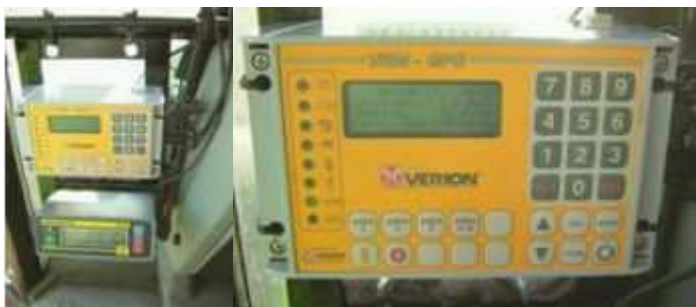
Fig 3:ubicación en el tractor del monitor Verion (arriba) y monitor de siembra Agrometal (abajo).
