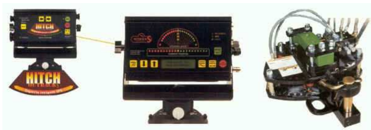
Banderillero satelital conectado con un control electrónico - hidráulico en la barra de tiro que corrige el error de operador en la guía con la barra de luces.
