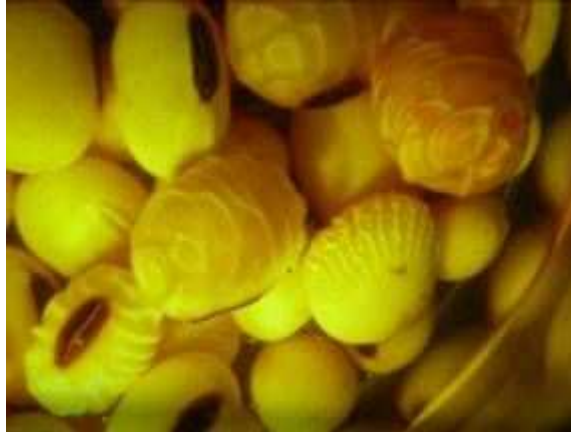
Figura 4. Detalle de semillas/granos hidratándose durante la Prueba de Hipoclorito. Fuente: Laboratorio de semillas del INTA Oliveros, 2005.
