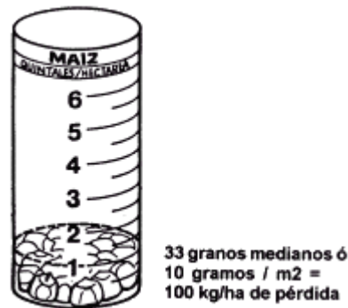
Figura 3. Recipiente evaluador de pérdidas en Maíz por lectura directa. INTA PRECOP.
