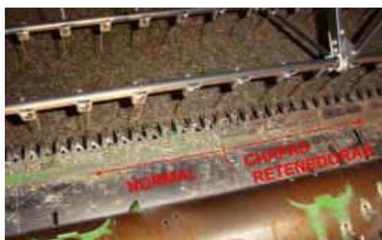
Figura 6. Vista superior del cabezal utilizado en el ensayo.
