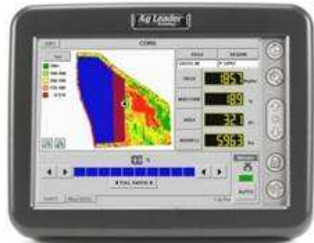
Figura 3. Pantalla del nuevo monitor Insight de AgLeader, mostrando la confección de un mapa de rendimiento en colores en tiempo real, superpuesto a un mapa de híbridos de Maíz.
