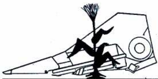
Figura 2. Espigado en la parte media del recorrido de los rolos. Fuente: INTA PRECOP Oliveros, 2006.
