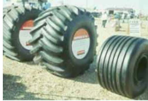
Fig. 4: Neumáticos de alta flotación, carcasa radial, baja presión de inflado. Reducen el huellado y la compactación superficial del suelo.
