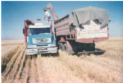
Fig 11: Nunca ingresar con camiones al rastrojo. El neumático de camión posee la máxima presión de inflado, por ende la máxima capacidad de compactación.
