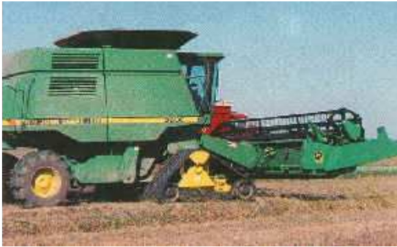
Fig. 3: Las orugas con banda de caucho fueron diseñados para reducir la presión específica sobre el suelo, pero poseen poca adaptación para funcionar en el barro.
