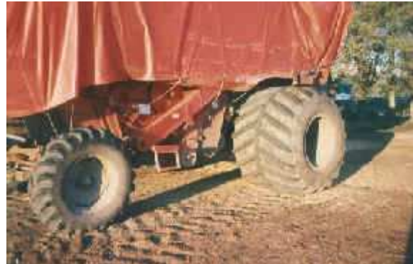
Fig. 6: Cosechadoras 4x2, neumáticos Terra Tyre, de baja presión de inflado, ideal para reducir el huellado en terrenos normales. Buena flotabilidad, baja compactación pero escasa tracción en suelos con falta de piso y barro.
