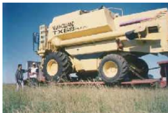
Fig 10: Cosechadora 4x4, aumento de flotabilidad por neumático de alta flotación y mayor diámetro trasero. Mejora en un 20% la flotabilidad y transitabilidad original.
