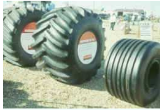
Fig. 4: Neumáticos de alta flotación, carcasa radial, baja presión de inflado. Reducen el huellado y la compactación superficial del suelo.
