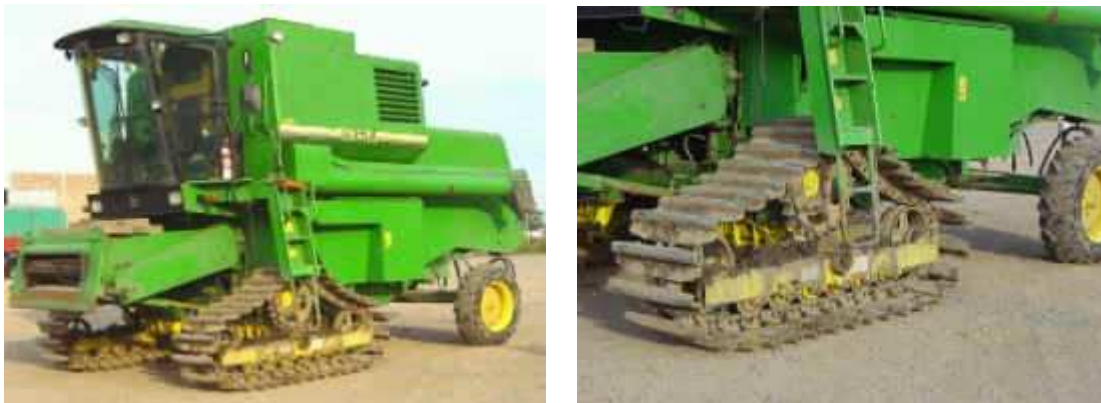
Fig. 2: Cosechadoras con orugas de metal tipo arrocera de buena prestación para situaciones de cosecha con agua en superficie.
