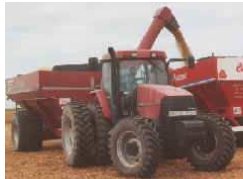
Fig 12: Los acoplados tolva deben ser traccionados por tractores 4x4 articulados, o 4x4 asistidos en lo posible con duales en el tren trasero.
