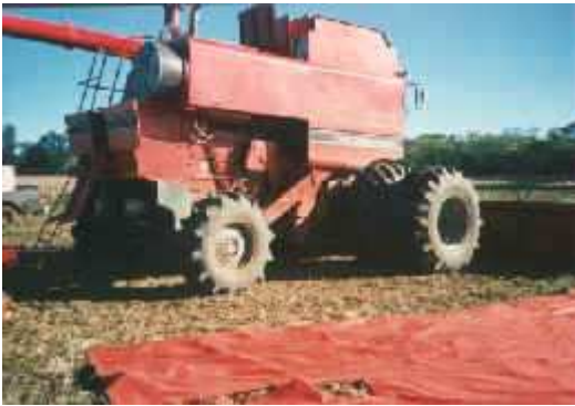
Fig. 5: Cosechadora 6x4, neumáticos duales delanteros y traseros tipo pala. Configuración de muy buena transitabilidad y traslado en situaciones de extrema humedad de suelo. Este equipamiento en cosechadoras de bajo peso es ideal.
