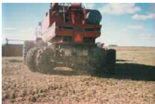
Fig 9: Cosechadora 8x4, vista trasera de un equipamiento ideal para transitar en situaciones extremas. Duales traseras, internas tipo pala, y delantera idem. Flotabilidad y alta tracción.
