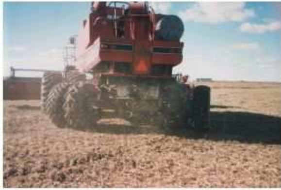
CASE 8x4, vista trasera de un equipamiento ideal para transitar en situaciones extremas. Duales traseras, internas tipo pala, y delantera idem. Flotabilidad y alta tracción.
