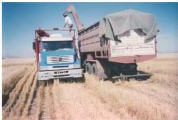
Nunca ingresar con camiones al rastreo. El neumático de camión posee la máxima presión de inflado, por ende la máxima capacidad de compactación.
