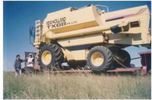
Cosechadora New Holland TX 68, 4x4, aumento de flotabilidad por neumático de alta flotación y mayor diámetro trasero. Mejora en un 20% la flotabilidad y transitabilidad original.
