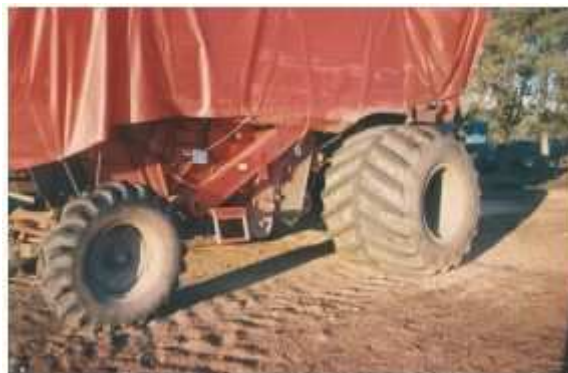
CASE 4x2, neumáticos Terra Tyre, de baja presión de inflado, ideal para reducir el huellado en terrenos normales donde se trabaje en SD continua.
