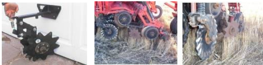
Figura 9. Diferentes diseños de barredores de rastrojo. Fuente. INTA Manfredi, 2006.
