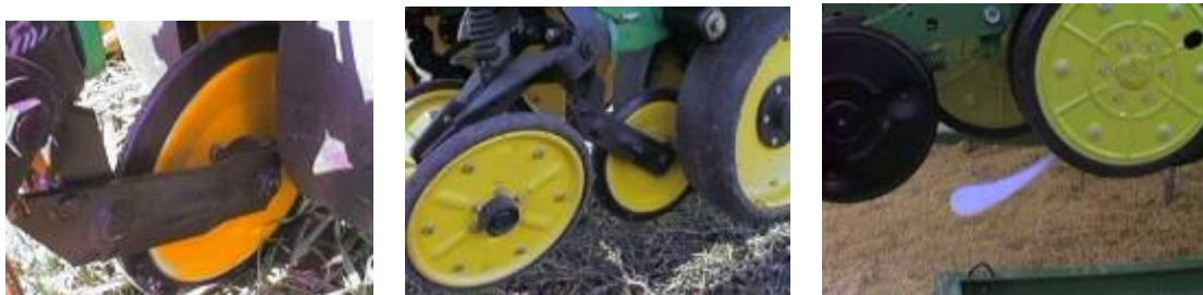
Figura 2. Vista lateral de ruedas fijadoras de grano (izq., centro) y de la colita plástica (der.). Fuente: INTA Manfredi, 2006.
