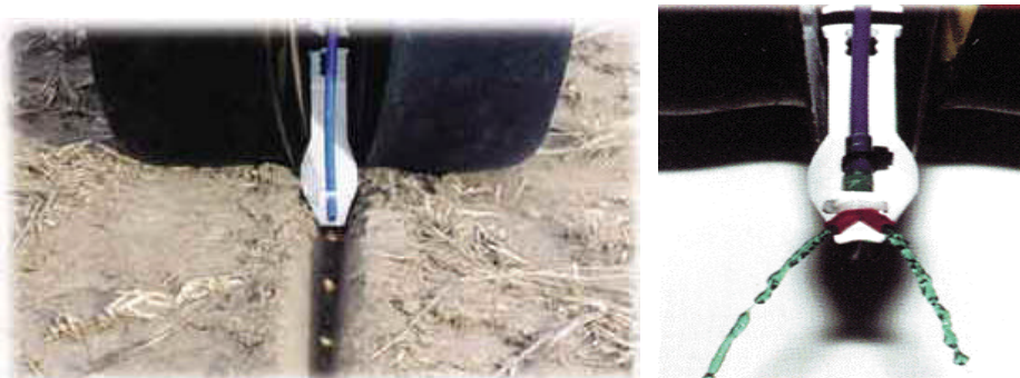
Fig. 2: Detalle de la colita plástica fijadora de grano, colocando fertilizante líquido a un costado de la semilla.
