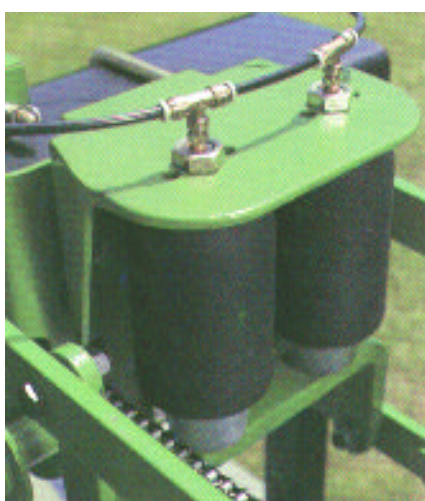
Figura 12: Pulmones neumáticos con carga constante en los paralelogramos de la sembradora de grano grueso. Tendencia en el desarrollo para mejorar la uniformidad de profundidad de implantación.
