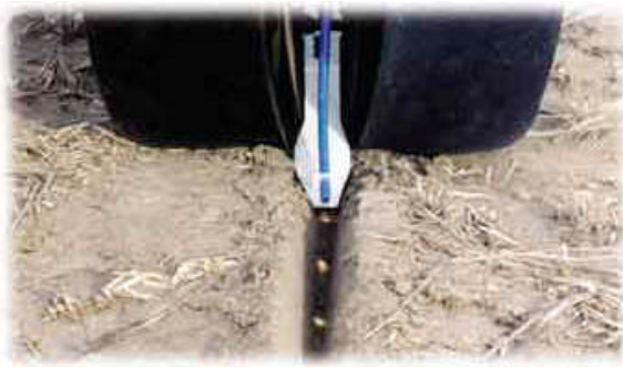
Fig. 2: Detalle de la colita plástica fijadora de grano, colocando fertilizante líquido a un costado de la semilla.
