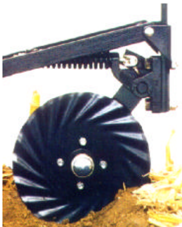
Fig.3: Detalle lateral de la cuchilla turbo y su eficiencia de corte de rastrojo y remoción en la línea de siembra.
