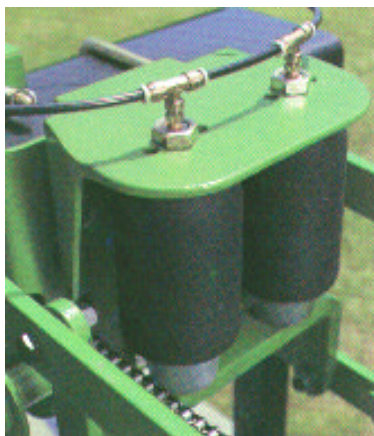
Figura 12: Pulmones neumáticos con carga constante en los paralelogramos de la sembradora de grano grueso. Uno de los tantos esfuerzos en desarrollo para mejorar la uniformidad de profundidad de implantación.
