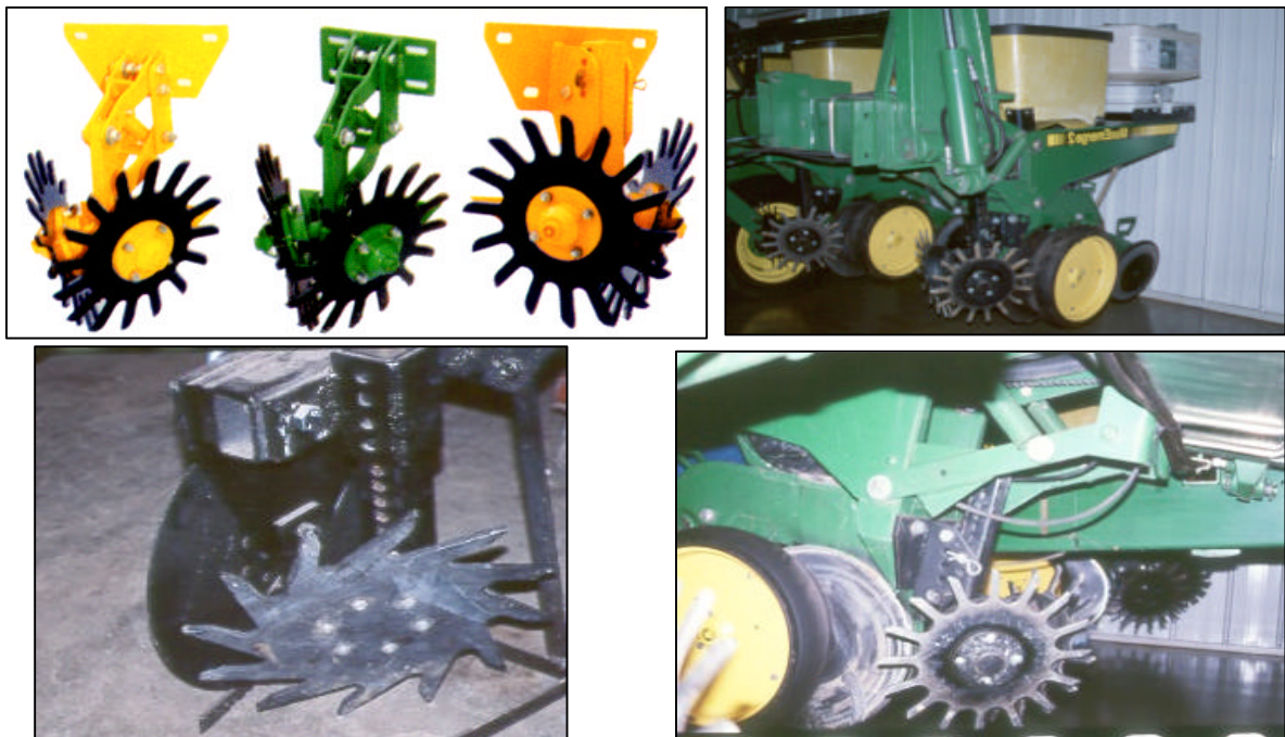
Figs. 4,5,6 y7: diferentes tipos de barredores de rastrojo articulados, fijos y su colocación en el cuerpo de siembra.
