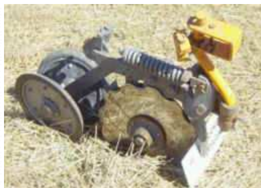
Tren de siembra (fertilizador) Ef. Implantación 56%
