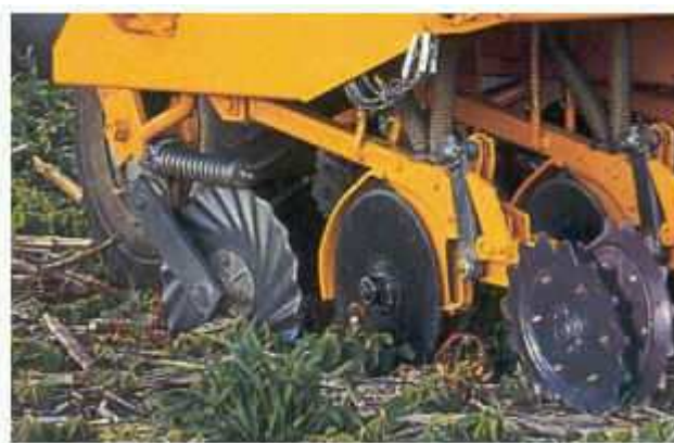
Tratamiento 2 – Copiado trasero. Ruedas tapadoras como limitadoras de profundidad
