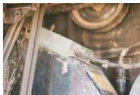
Fig 6: sensor de flujo de retorno por placa de impacto.
