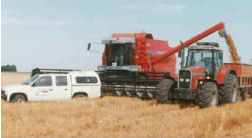
Fig 8: realizando la calibración del sensor de flujo de grano. Se logró una precisión de medición del peso del 1%.
