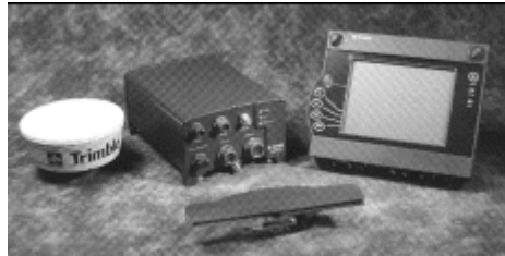
Fig. 12: Equipo aéreo con pantalla digital y barra de luces
