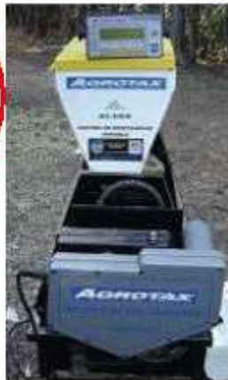
Fig. 6: Equipamiento mecánico para aplicación de dosis variable de fertilizante. Puede aplicar en tiempo real mediante una prescripción realizada en una computadora palm top más un programa de agricultura de precisión (Farm Site).
