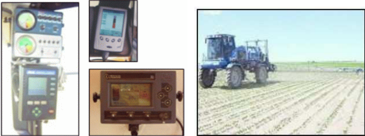
Fig. 9: Equipamiento disponible en pulverizadoras para realizar dosis variable de fertilizantes líquidos chorreados en tiempo real por medio de una recomendación más GPS o en forma manual. En tiempo real más recomendación la opción podría ser una palm top con software de dosis variable o monitores específicos que son navegadores. Pulverizadora equipada para pulverizar y fertilizar al mismo tiempo (2 tanques, 2 botalones y 2 computadoras).
