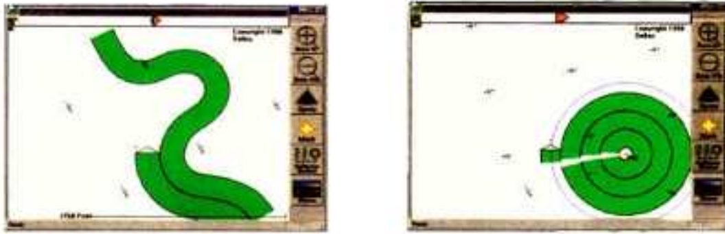
Figura 6: uso del banderillero satelital para aplicaciones siguiendo curvas de nivel y círculos de riego
