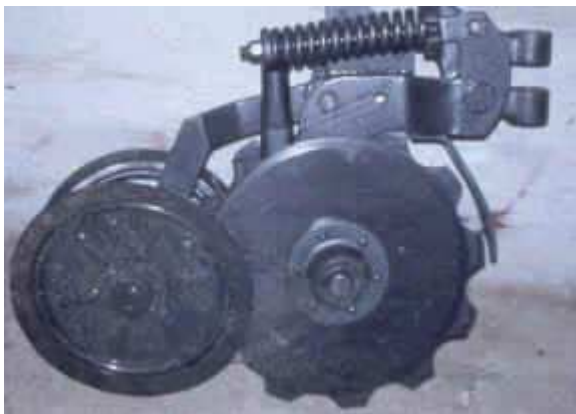
Fig. 4: Detalle del cuerpo fertilizador que se utilizó para sembrar la soja a 26 cm.
