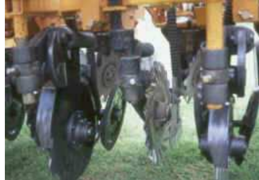
Fig. 3: Disposición de los cuerpos entre líneas (26 cm) en la mitad derecha.
