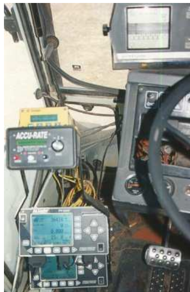
Figura 12: monitores para siembra y fertilización variable, Accu Rate, GPS y monitor de siembra.
