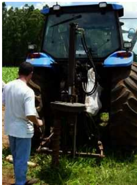
Figura 2: equipo para la toma de muestras de suelo.
