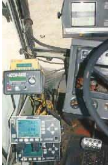
Figura 13: monitores para siembra y fertilización variable, Accu Rate, GPS y monitor de siembra.
