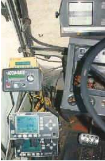
Figura 13: Interior de la cabina del tractor que muestra el equipamiento utilizado para realizar dosis variable.
