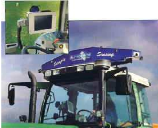
Fig 30: sensor de Nitrógeno montado sobre la cabina del tractor. Detalle de la consola
