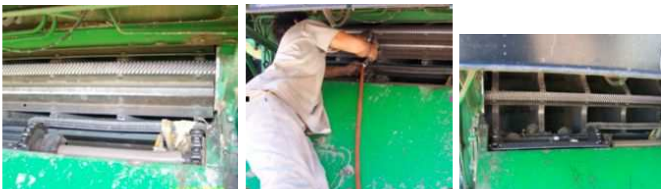
A la Izquierda: vista del cilindro de trilla forrado. Al medio operario quitando las chapas. Derecha vista del cilindro sin forrar.
