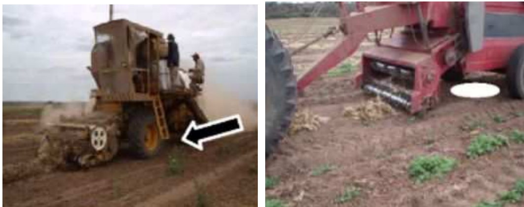
Figura 7. Detalle de la ubicación del aro ciego mientras la cosechadora se desplaza.
