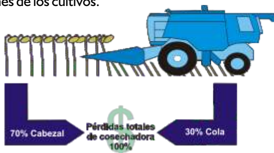
Figura 1: Porcentaje de pérdidas de cosecha totales producidas por el cabezal y por el resto de la cosechadora de Girasol
