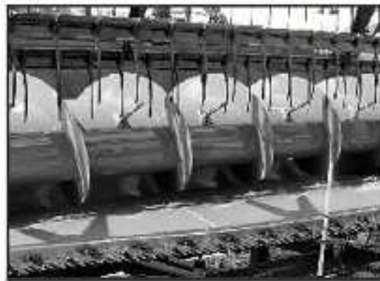
Figura 11. Sinfín con dedos retráctiles en todo su ancho.
