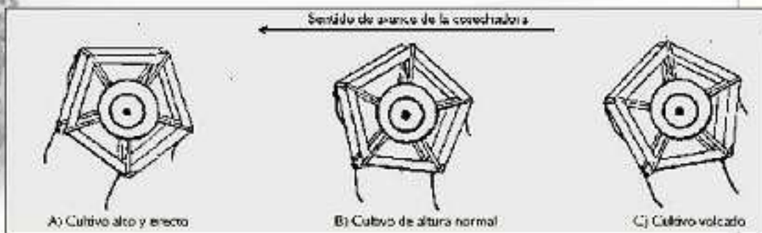
Figura 7. Posición de los dientes del molinete de acuerdo al estado del cultivo.
