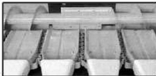
Figura 10. Detalle de los puntones de recolección agudos, batea de captación y cadena de guía y transporte.
