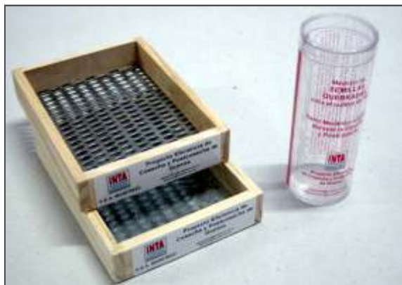
Figura 2. Kit evaluador de granos partidos de soja, del INTA PRECOP.
