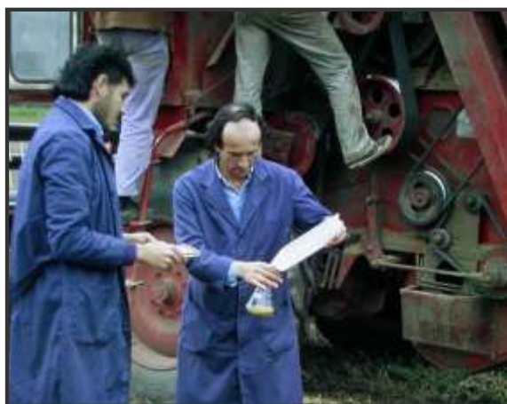
Figura 4. Realización de la Prueba de Hipoclorito al pie de la máquina cosechadora. Fuente: Laboratorio de semillas del INTA Oliveros, 2005.
