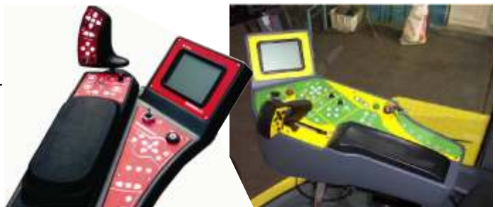
Figura 9. Ejemplos de consolas de mandos nacionales para cosechadoras de última generación. Izq.: Vasalli I 550, der.: Metalfor Araus.
