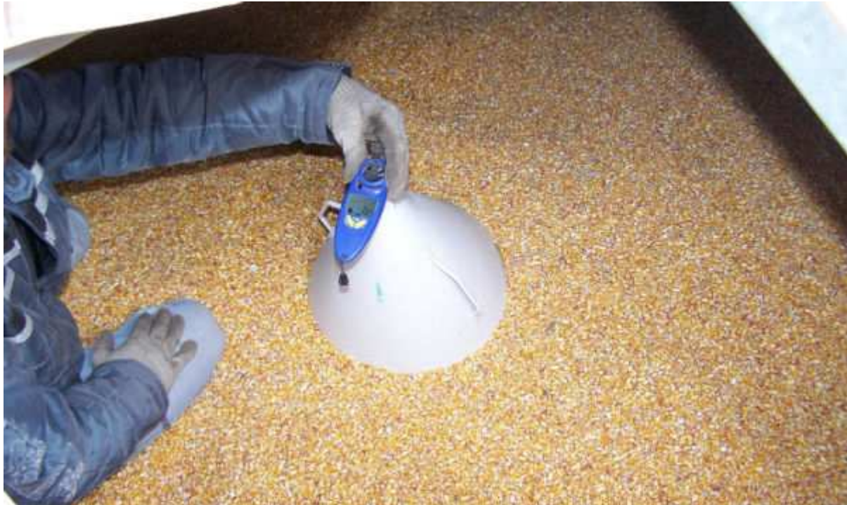
Figura 4: Medición del caudal de aire en la masa superior de granos.
