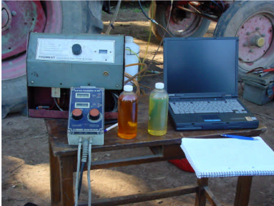
Equipo de control del freno dinamométrico, medidor de combustible muestras de biodiesel y gasoil empleados.
