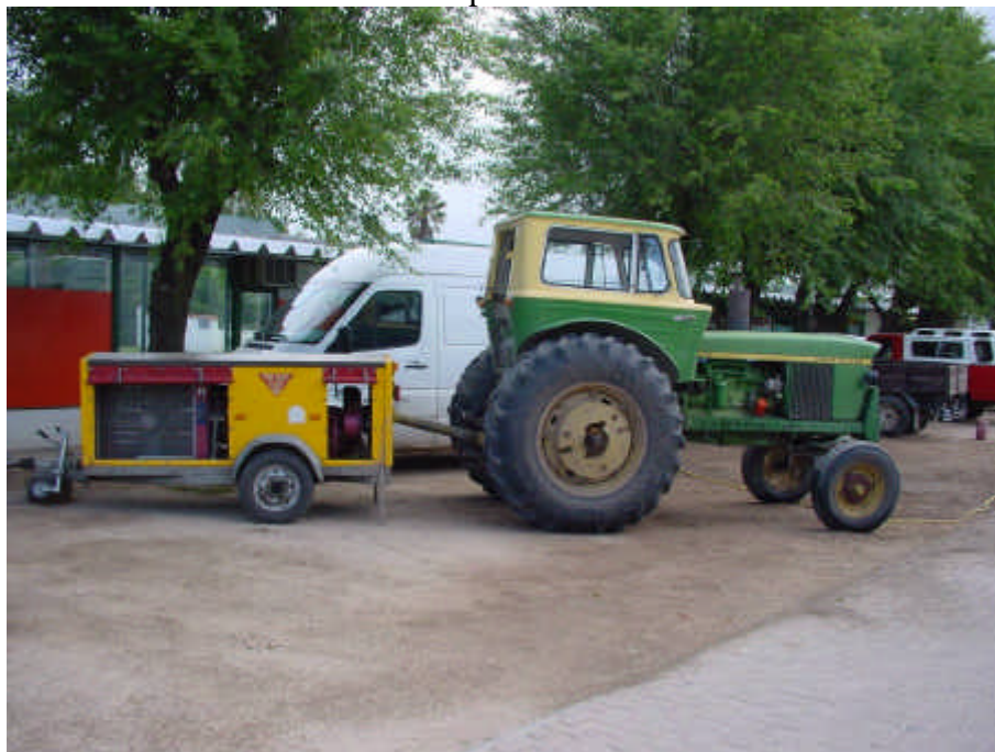
Ensayo dinamométrico tractor John Deere Rio IV
