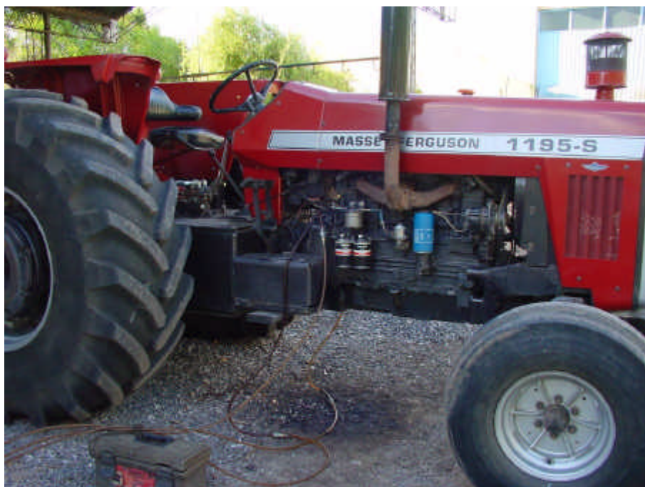
Intervención en el sistema de combustible
