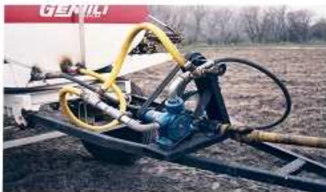
Bomba de presión a turbina - caudal 12.000 lts./hs.
