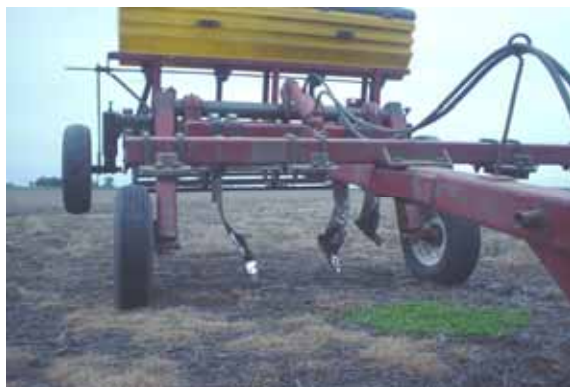
Figura 1 -Equipo para descompactar y agregar fertilizantes y/o enmiendas al suelo
